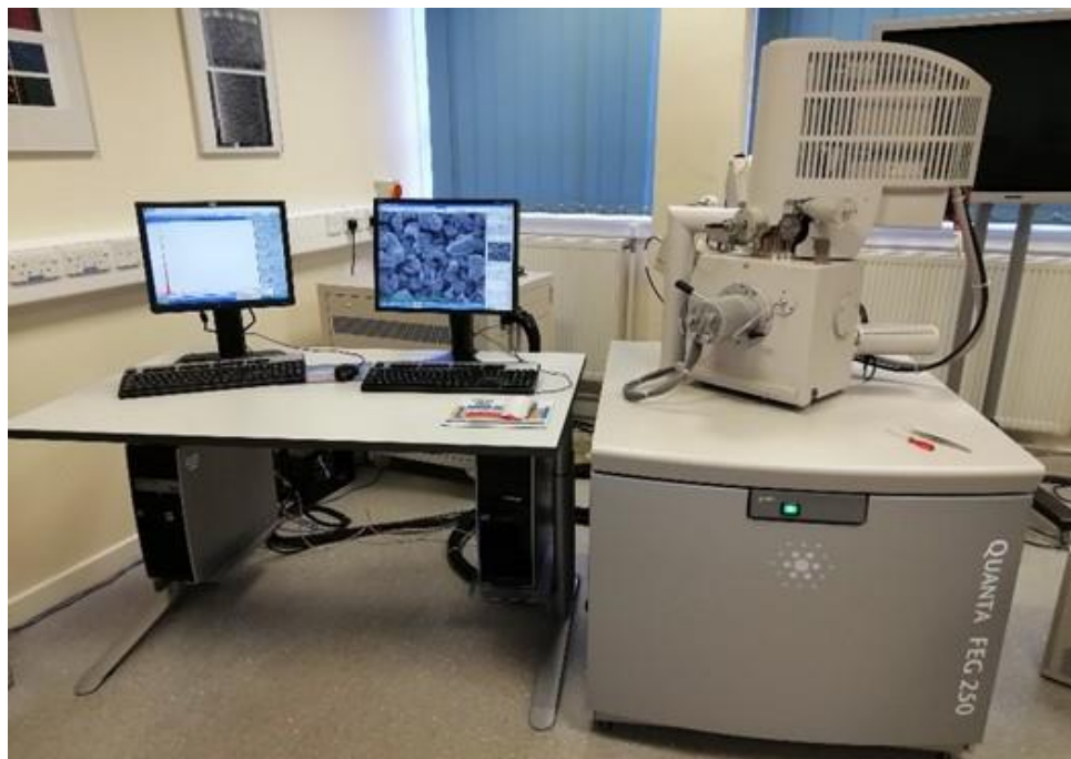
Figure 3.17: FEI Quanta FEG250 SEM
